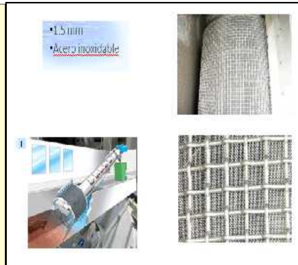
Figure 8. Prétraitement par dégrillage
